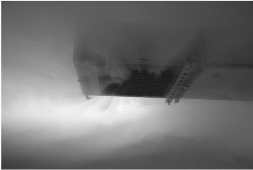
Fot. 1. Krata wyciągowa przy której zaobserwowano zjawisko przeciągania
