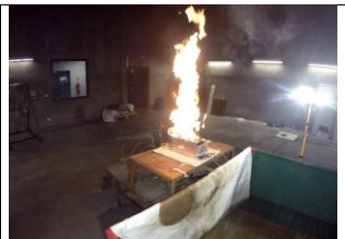
Rysunek 2 Rozszczelnienie się wentu i uwolnienie dużej objętości gazów rozkładowych oraz ich natychmiastowy zapłon
