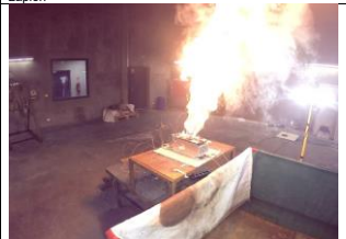
Rysunek 4 Rozerwanie kolejnego wentu i gwałtowny jet powstały w wyniku zapłonu gazów
