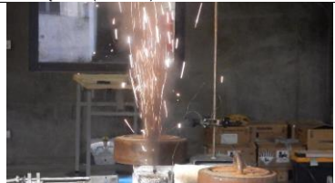
Rysunek 3 Pojawienie się stałych produktów rozkładu w formie żarzenia (torch on)
