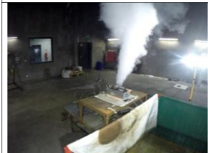
Rysunek 3 Ponowny wypływ gazów rozkładowych
