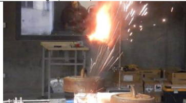
Rysunek 4 Pojawienie się stałych produktów rozkładu w formie żarzenia i płomienia (torch on)
