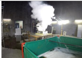
Rysunek 2 Rozszczelnienie się wentu i uwolnienie dużej objętości gazów rozkładowych
