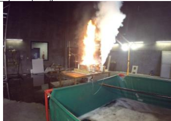
Rysunek 6 Jednoczesny płomień (jedna cela) oraz wyrzut gazu (druga cela). Można obserwować wzrost objętości cel zjawisko puchnięcia
