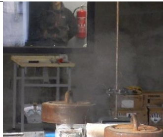
Rysunek 2 Otwarcie wentu celi LTO wyrzut gazu rozkładowego (torch on)
