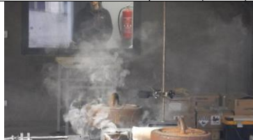
Rysunek 6 Wyrzut gazu rozkładowego (torch off), dalszy spadek dynamiki wyrzutu gazów
