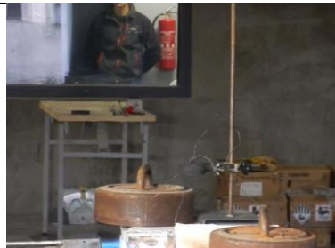
Rysunek 1 Oddziaływanie płomienia zewnętrznego na celę LTO (torch on)
