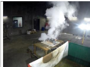
Rysunek 1 Znaczną objętość gazów wydobywającą się przez wenty
