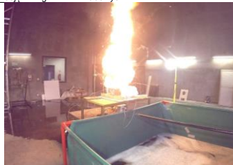
Rysunek 4 Rozzerwanie wentu i gwałtowny jet powstały w wyniku zapłonu gazów
